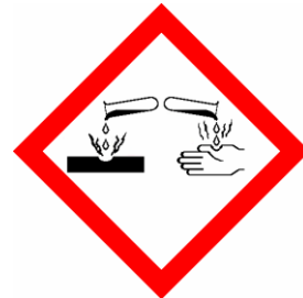
auf Metalle korrosiv wirkend
