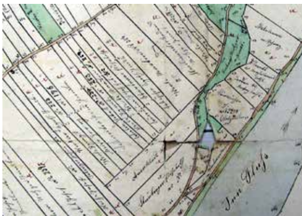
Abb. 3 Indikations- oder Feldskizze Katastralgemeinde Hötting bei Innsbruck (Nr. 84). In die eingemessenen Fluren sind noch die Besitzer namentlich mit den vorläufigen Parzellen- nummern und Mess- punkten eingetragen. © BEV-Innsbruck.
