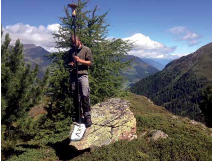
Bild 2 Kontrolle eines Grenzpunktes im Hochgebirge mittels GPS-Rover
