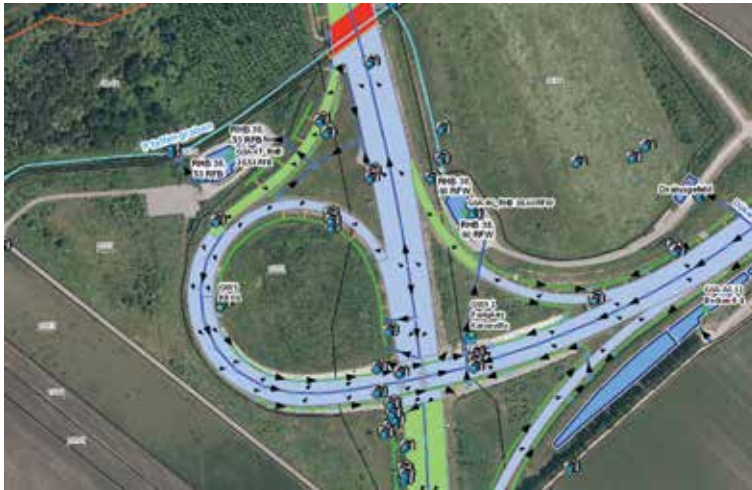
Abb. 1 Wartung der Entwässerungsinfrastruktur (Leitungen, Entwässerungsabschnitte, Fließrichtungen)
