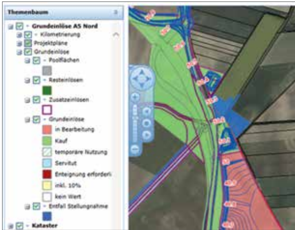
Abb. 5 Grundeinlöse auf der A5 Nord Autobahn
