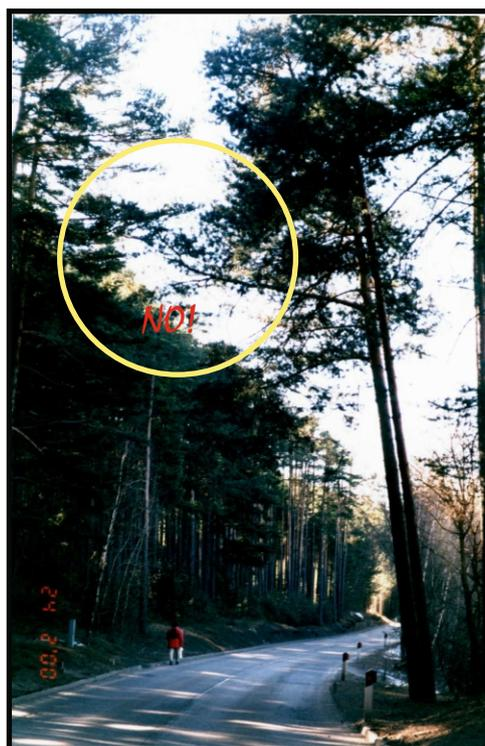
5) ostacolo alla visibilità delle opere d'arte causata dalla vegetazione spontanea con pregiudizio del controllo visivo dello stato di conservazione (fessure, cedimenti ecc.) di muri di sostegno, pile di ponti e viadotti ecc.
