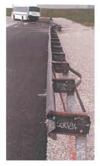
Es ist anzumerken, dass die Crashtests mit der Endgruppen montierten Leitplanke durchgeführt wurden, so dass diese Elemente keinen Einfluss auf das statische Verhalten der Leitplanke haben.
